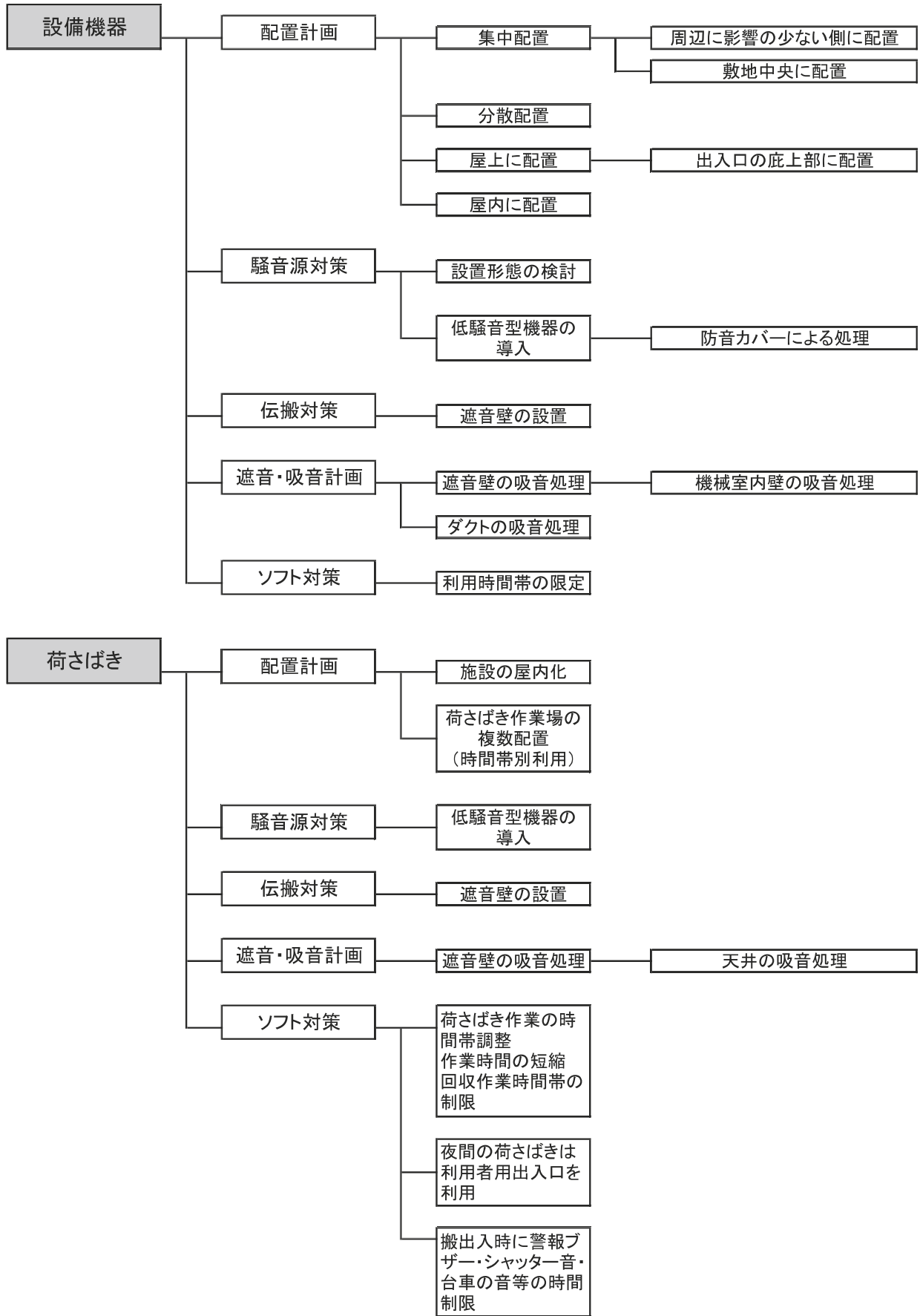
図 1-9 (1) 騒音源ごとにみた騒音対策事例①
