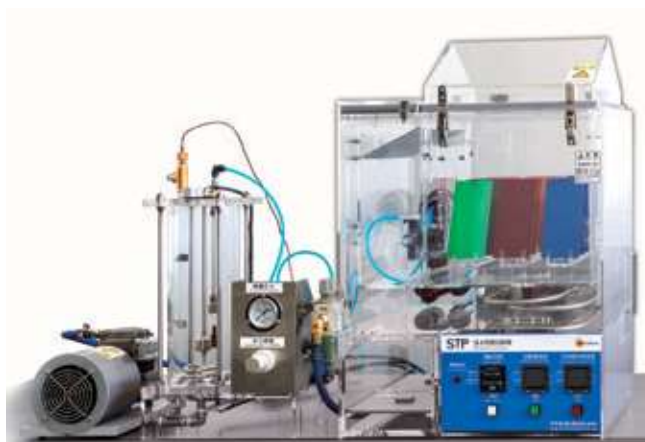
卓上設置型の小型塩水噴霧試験機「STP-30」
