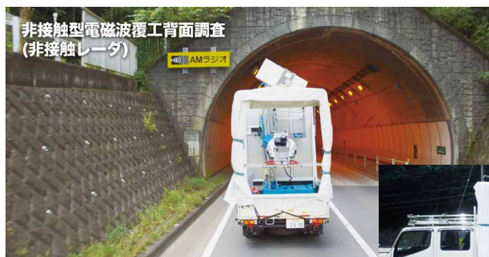
走行診断 (非接触型レーダ)
