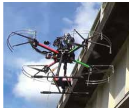
図表7. 非破壊検査用ドローン (出典7)
