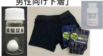
再現性に難のある尿臭に関して、官能評価を通じて模擬尿臭を開発するとともに、尿臭の評価方法を確立。本技術を用いて消臭効果の実証に成功
