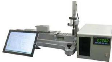
自社校正が可能となる汎用型全自動精密傾斜校正装置を開発。デジタル精密水準器の校正作業時間を大幅に短縮(3.5h→0.5h)(2022年度販売開始)
