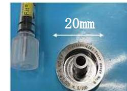
精密加工業の支援を目指して導入したレーザー加工機を用い、医療注射器用検査治具への微細文字の深堀りレーザー加工を検証
