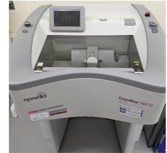
導入した凍結切片製作装置
