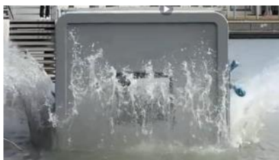
船舶の落水衝撃試験に耐える強度
