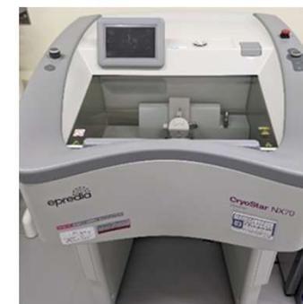
導入した凍結切片製作装置
