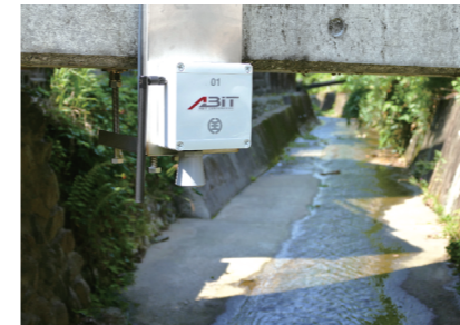
エイビットが開発した小型・軽量の水位計測センサー
