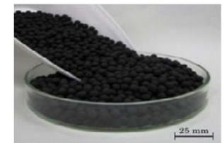
VOC 分解触媒（粒径 6 mm）
