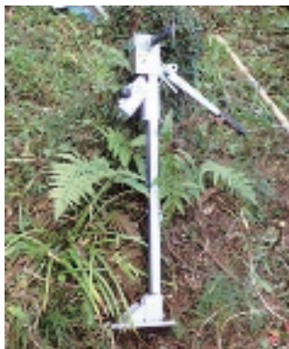
写真－1 杭抜き器「ぬく象」
