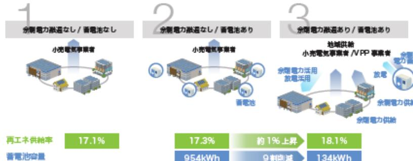
余剰電力融通により据点全体の再エネ供給率が約1%上昇、必要な蓄電池容量を9割削減できることを確認した。都立大学等の電力需要の大きい施設では、発電した再エネの大半が自家消費されるため、据点間で融通できる余剰電力が少なく、再エネシェアリングの効果が限定的だった。
