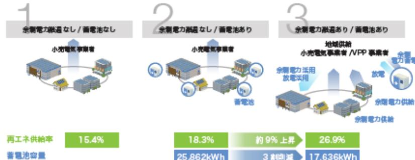
余剰電力融通により地区全域の再エネ供給率が約9%上昇、必要な蓄電池容量を約3割削減できることを確認した。集合住宅、戸建て等の電力需要の小さい施設では、発電した再エネの大半が余るため、地区全域で融通できる余剰電力が多く、再エネシェアリングが効果的だった。
