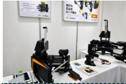
枝打ちロボット「eddy」など、 高所作業の無人化技術
