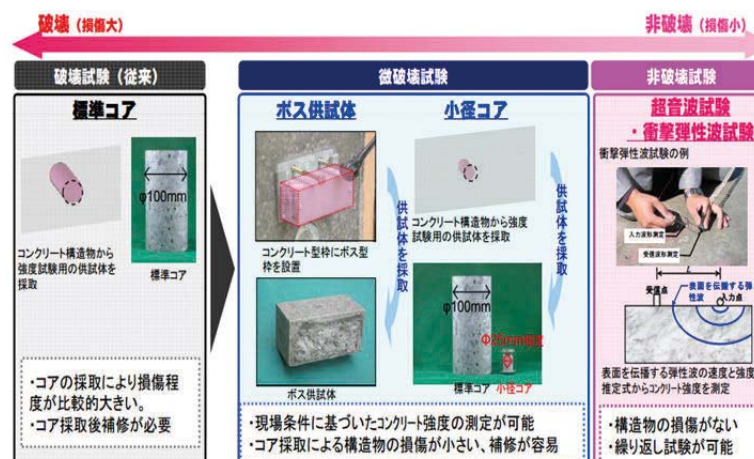
図表4 微破壊・接触検査技術の構成例（出典3）
