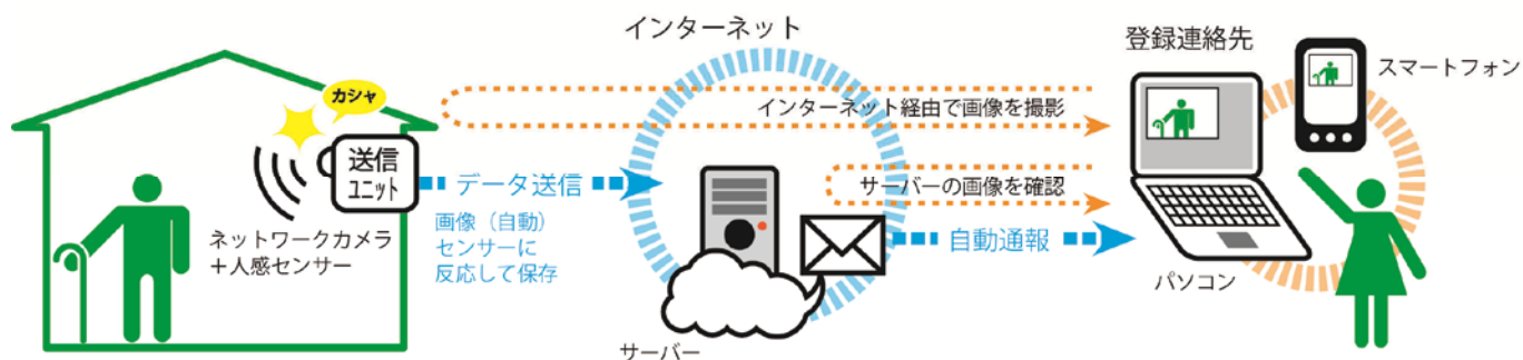
図表3 ネットワークカメラ/センサーによる見守りシステム例
