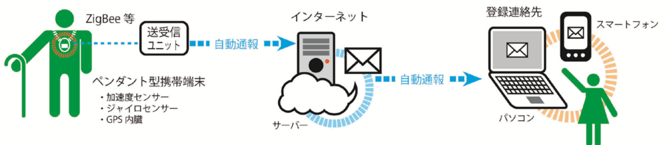
図表 2 ペンダント型携帯端末による行動・転倒検知システムの例
