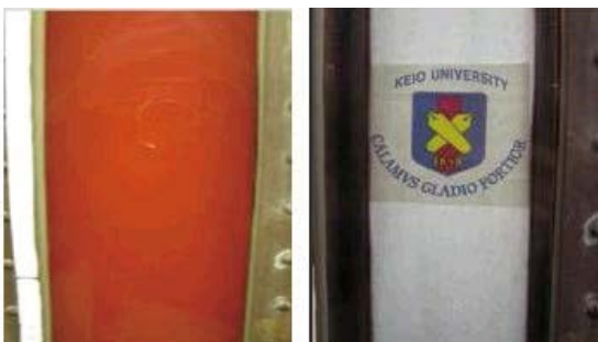
図表 1 4 マイクロバブルを利用した酸化鉄 微粒子除去プロセス（出典 1 3）
