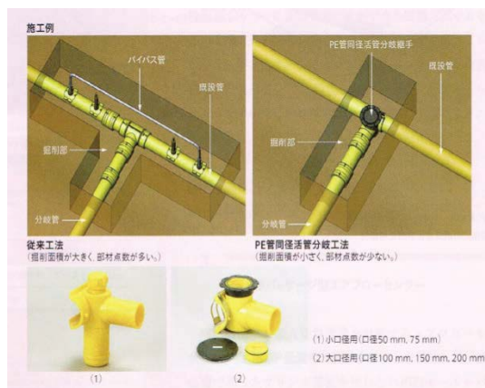
図表 12 ポリエチレングス管同径活管分岐継手(出典 10)
