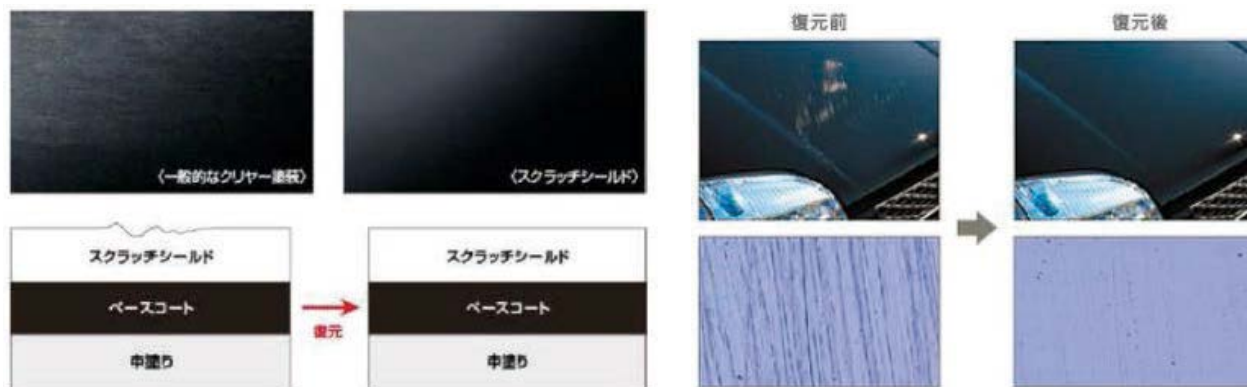
図表 8 自己修復材料による自動車のコーディング塗料(出典 7)
