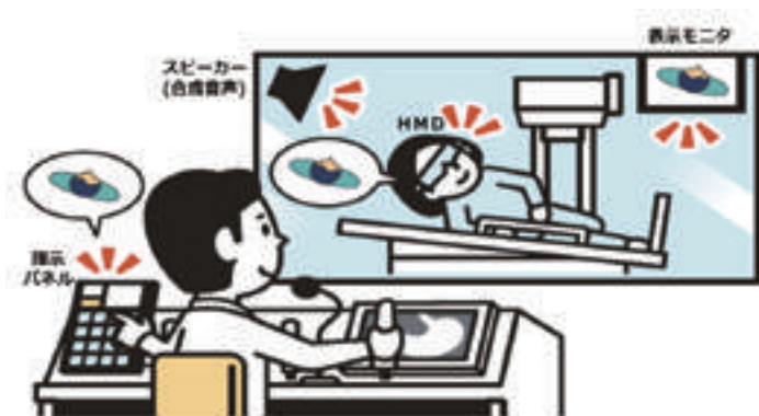
検査指示をわかりやすく伝える胃部X線検査支援システム
