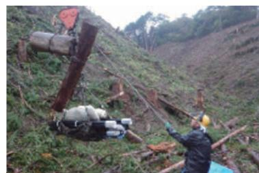
架線を用いた防護柵資材とコンテナ苗の運搬
