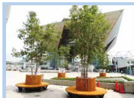
可搬式コンテナ緑化システムの実証試験
