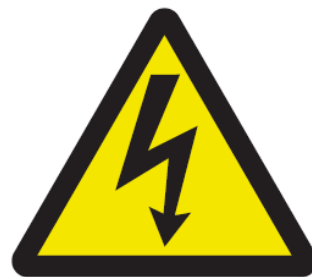
感電注意 Caution, electricity [注1] (文字による補助表示が必要)
