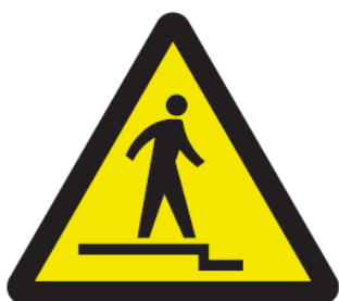
下り段差注意 Caution, uneven access / down
