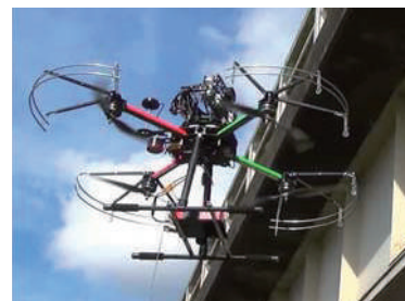
図表 6 非破壊検査用ドローン（出典 6）
