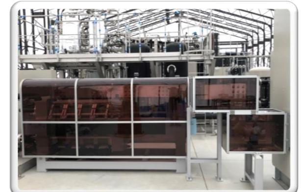
1.5 MW水電解装置
