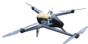
災害調査/気象観測用 高速巡航型ドローン （点検支援）
