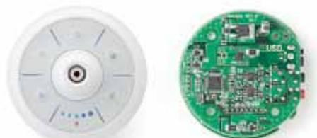
アンプ部の操作パネルとデジタルアンプ回路
