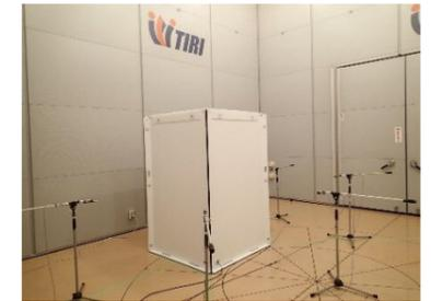
性能向上の為の吸音材設置位置などを提案。評価方法を検討し、遮音効果を定量的に評価。音漏れ箇所等の特定や改善提案を経て、10月20日に販売開始。
