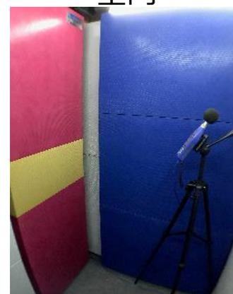
吸音ユニットで作製した簡易型音響試験室（無響室）
