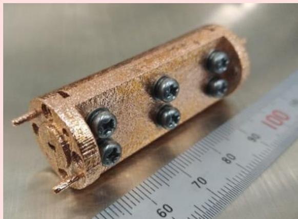
AMにより成形し、めっき処理を施したプラスチック製導波管
