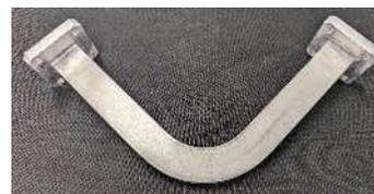
航空機に搭載する方形管の曲げ加工について、電磁波の導通障害となるしわが少なく、割れが発生しないような特殊加工方法を共同開発
