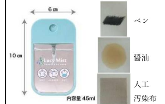
皮脂・ペン・醤油等の汚れ除去効果を測色計で数値化。安定した効果測定のために人工汚染布を提案
