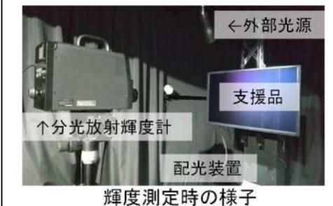
直接光と反射光の物理特性の定量的検証について相談を受け、輝度の角度分布計測を提案。一般的な直接光型と、反射光型との差異検証に貢献
