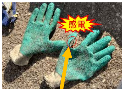
電気の流入箇所（推定）
