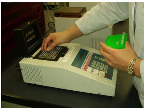
PCR 法は、特定の部分の DNA を爆発的に増やすことができる技術です。PCR には「サーマルサイクラー（遺伝子増幅装置）」という機械が使われ、この機械がないと PCR はできません。KHV 診断の PCR では、鰓から取り出した DNA の中にウイルスの DNA があった場合、その一部をもとの 10 億倍（理論上）にも増やします。DNA の量を増やすことによって、電気泳動や染色などの操作によって、ウイルスの存在を目で確認することができるようになります。
