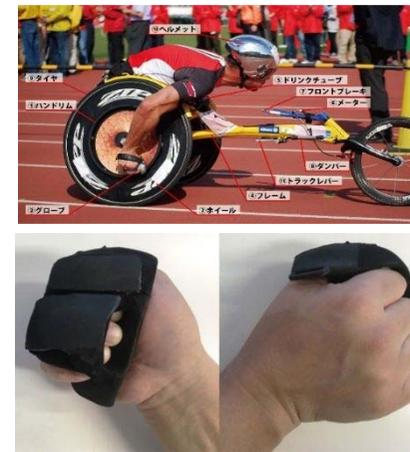
3Dデジタルで実物の形状データを取得。樹脂AMで一点物を造形
