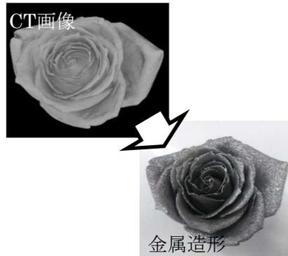
バラの花をX線CT装置で3次元モデリング化、金属AMで造形
