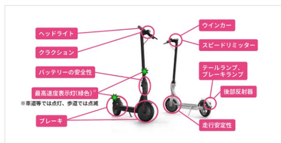
図表 59. 特定小型原付に必要な保安装置（出典5）
