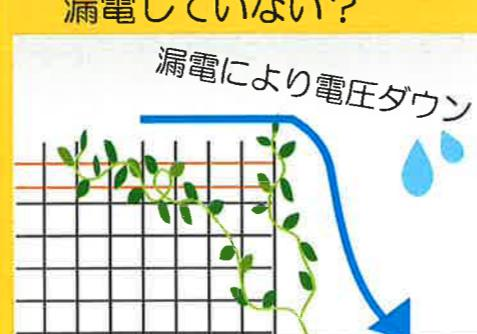
漏電により電圧ダウン
