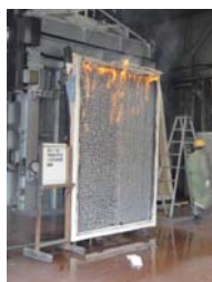
木層ウォール試験体 燃焼実験の様子
