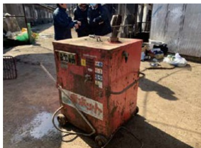
事故当時：高圧洗浄機をパレット上に設置
