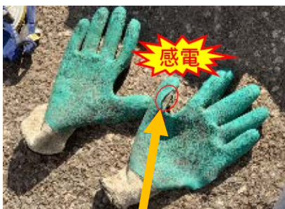
電気の流入箇所(推定)
