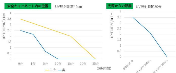
図7 設置場所によるウイルス不活化の違い
