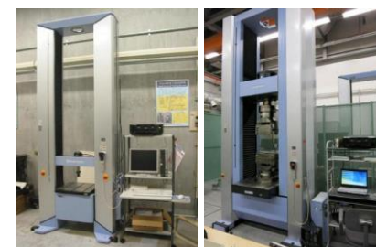
万能試験機 製品や部材などの強度を評価
