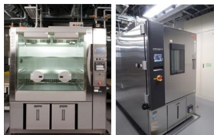
温度・湿度試験装置 温湿度環境での製品の動作を確認
