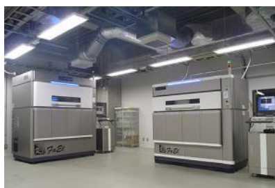
造形機 機械部品、電子機器、医療機器、玩具などの部品を試作
