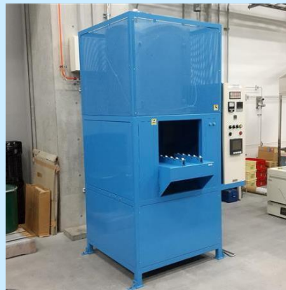
霧困気熱処理炉 (更新)
