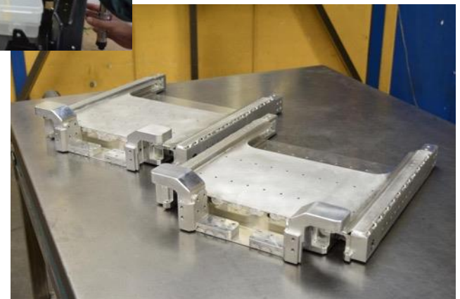
機能性と実用性を追求した車体フレームの開発。軽量化に向け、アルミを使用。難度の高い溶接が要求される。
